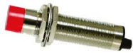
C18 Sensor capacitivo M18. Distância 8mm. 12-24VCC - NPN ou PNP. 90~250VCA 2 fios.
