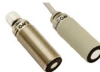
UK6 Sensor ultrassônico M18 corpo curto. Modelos tipo difuso ou retrorefletivo para distâncias de até 1.200mm. Corpo plástico ou metálico. Saída analógica ou digital programável. Modelo com certificação ATEX disponível.
