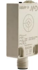
CQ55 Sensor capacitivo retangular. Possui dimensões de 55 x 35 x 15mm e distância de atuação de 4 a 25mm ajustável. Alimentação de 10-40VCC. Saída NPN ou PNP.
