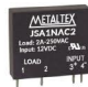
JSA Saída Triac com zero-cross, montagem em PCI. Saída 1NA - 2A, 75 a 264VCA. Comando 12 ou 24VCC. 24 x 20 x 6,5mm.
