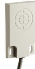
CQ50 Sensor capacitivo retangular. Possui dimensões de 50 x 30 x 7mm e distância de atuação de até 10mm sem ajuste. Alimentação 10-30VCC. Saída NPN ou PNP.
