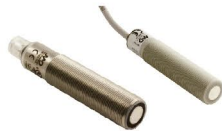
UK1/UKR1 Sensor ultrassônico M18. Modelos tipo difuso ou retrorefletivo para distâncias de até 2.200mm. Corpo plástico ou metálico. Saída analógica e/ou digital programável. Modelo com certificação ATEX disponível.
