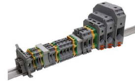
BS Conector de passagem com conexão por parafuso fenda/philips. Modelos para cabos de 2,5 até 150mm 2 . Montagem em trilho TS35. Partes metálicas com acabamento níquelado. Material plástico de alta resistência.
