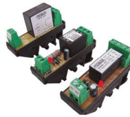
Q Relé soldado na PCI. Disponível com relé eletromecânico ou de estado sólido. Sistema de conexão por parafuso. Vários arranjos de contato, 1NA, 1NF, 2NA, 2NF, 1NA1NF, 1 rev., 2 rev. Disponível nas tensões 12, 24, 48, 110 e 220VCA/CC.
