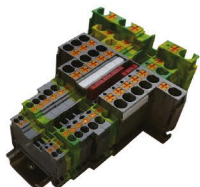
BP Bornes tipo mola com tecnologia push-in. Não necessita de ferramenta para inserção. Modelos de 1,5, 2,5, 4, 6 e 10mm 2 . Opções com 2, 3 ou 4 entradas para cabo.
