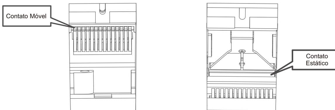
**Inspeção de Superfícies de Contato**
