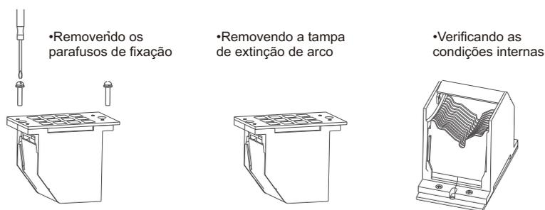
**Inspeção para a câmara de extinção de arco**
